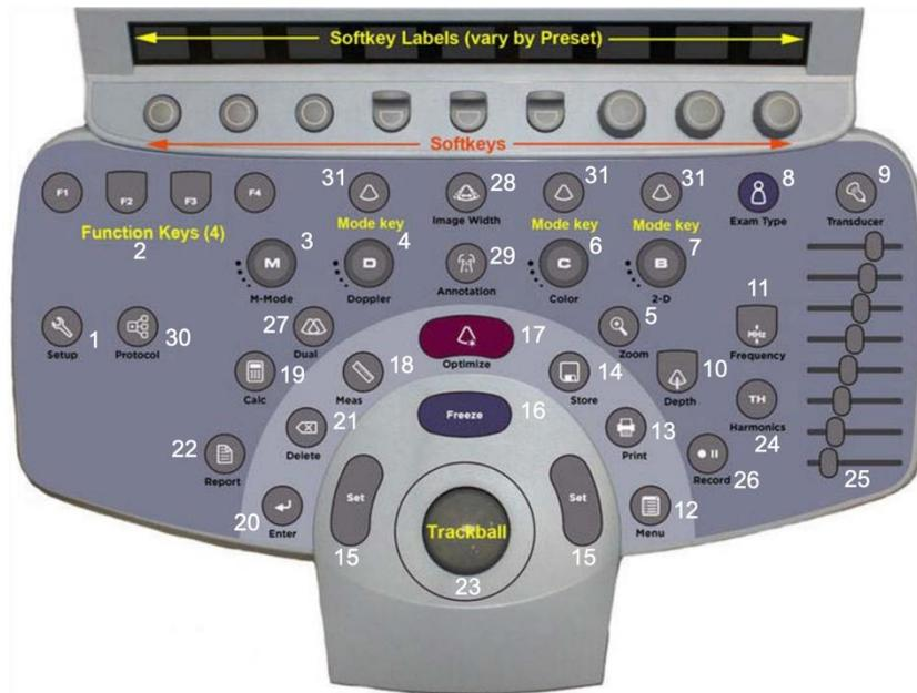
1. Sondenwahl: Knopf Nr 9 „Transducer“ dann bei den „Softkeys“ oben rechts denjenigen Auswählen welcher „L14-5sp“ anzeigt. Wird das nicht angezeigt dann ist die Hocke-stick Sonde nicht eingesteckt.
